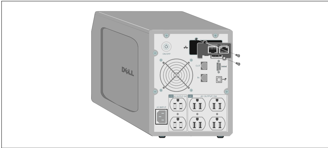
Figura 4. Instalación de la tarjeta
